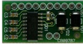
Рис. 4 Интерфейсная плата (RS-485 -> RS-232)
