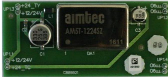
Рис. 5 Плата конвертора 12/24В
