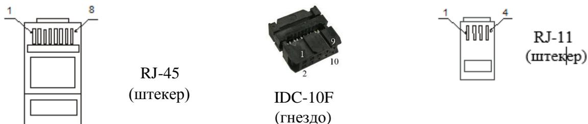
Рис. 3 Расположение контактов разъемов
